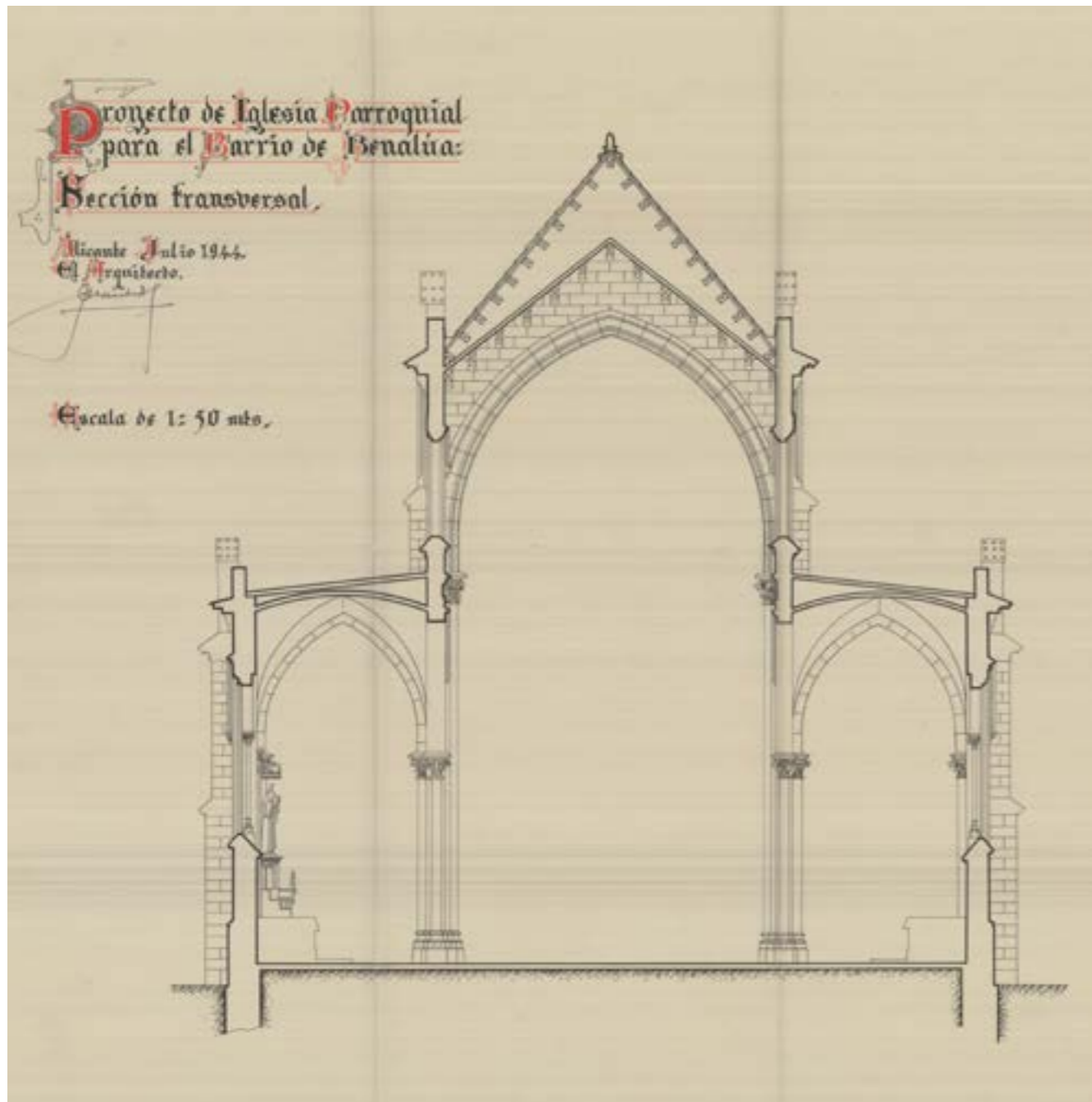
Figura 2. Sección de las naves.
