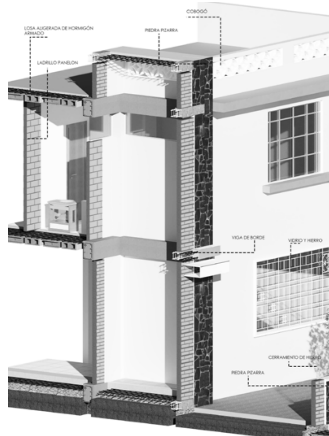
Figura 18: Sección constructiva 02 (3D)- Residencia Valdivieso.
